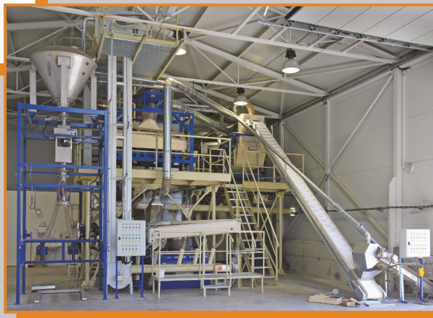
Anlage zur Aufbereitung von Mohn
